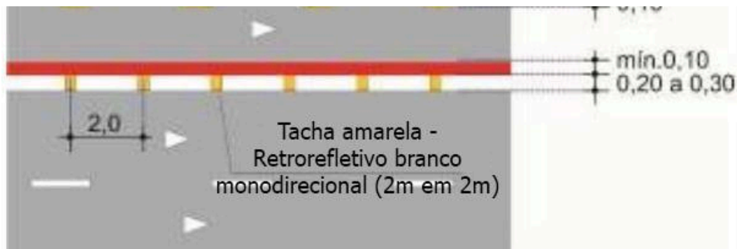
Figura 1 - Exemplo de tachas amarelas instaladas sobre linha demarcada em cor branca
