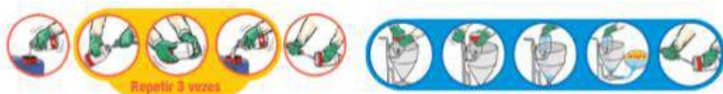
FIGURA: TRÍPLICE LAVAGEM E LAVAGEM PRESSÃO DAS EMBALAGENS DE AGROTÓXICO. Fonte: inpEV, 2006.
